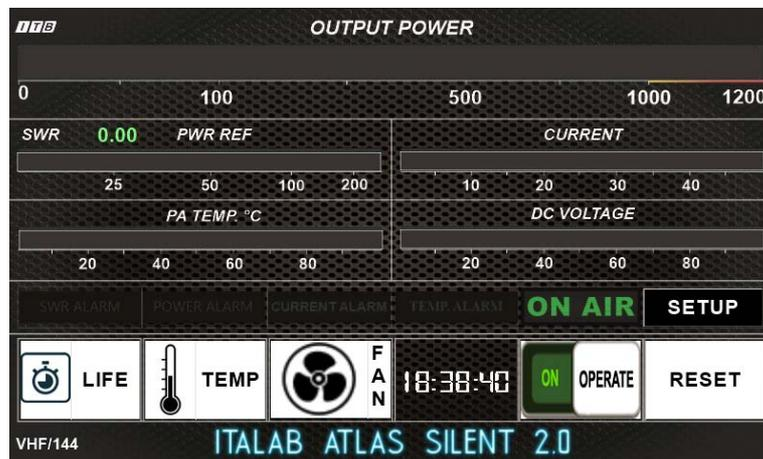
All'accensione le Ventole saranno settate nel modo confort (vds sezione FAN) ed **Operate Abilitato** (pronto per il PTT) (1ª Accensione).
