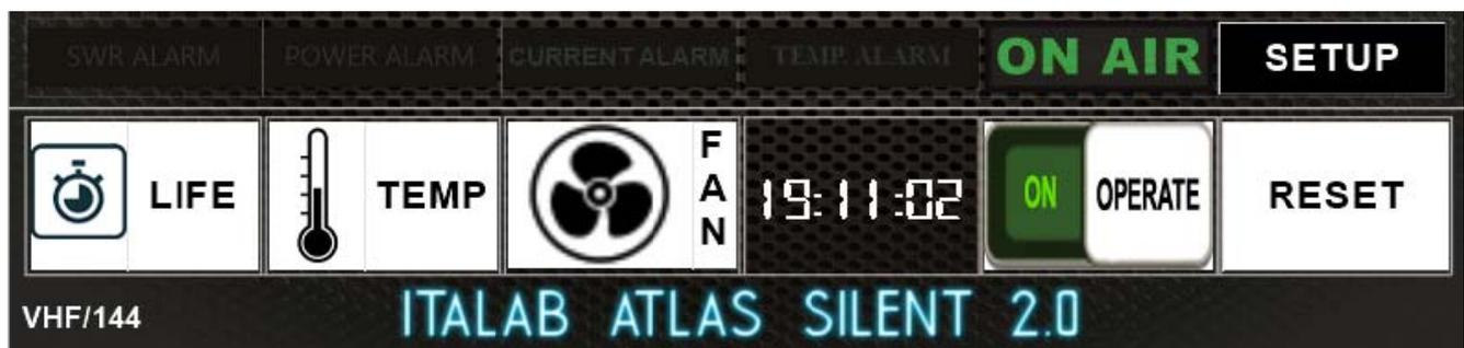
**ON AIR** ha 3 colorazioni ad indicare i vari modi del PTT, colore NERO **ON AIR** indica che il PTT è disabilitato (vedasi comando tasto Operate Off-On), Colore VERDE **ON AIR** indica che il PTT e' abilitato (Operate ON), colore rosso **ON AIR** indica che siamo in Trasmissione.
